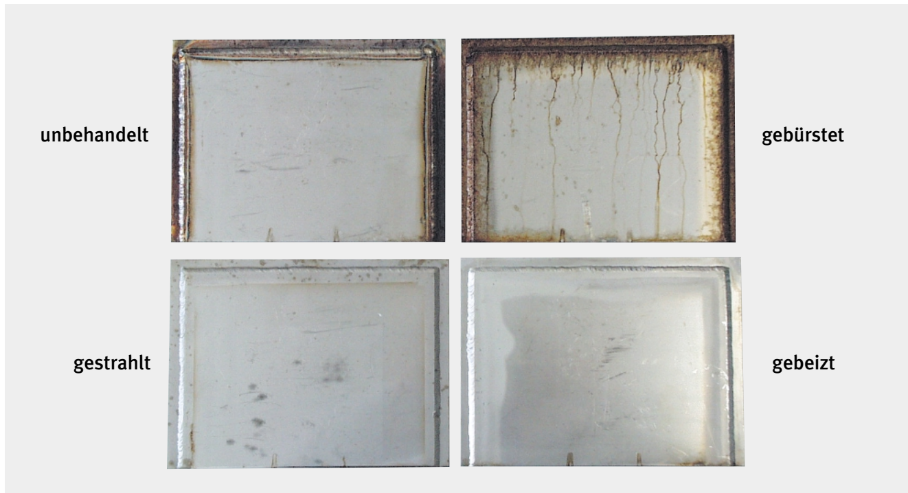
Bild 4: Verarbeitungsbedingte Oberflächendefekte: Einfluss von Schweißnahtanlauffarben und verschiedener Nahtnachbehandlungen auf das Korrosionsverhalten des nichtrostenden austenitischen Stahls 1.4401 (Oberfläche 2R) über 60 Zyklen einer Laborklimaprüfung (Foto: ThyssenKrupp Nirosta GmbH, Krefeld)
